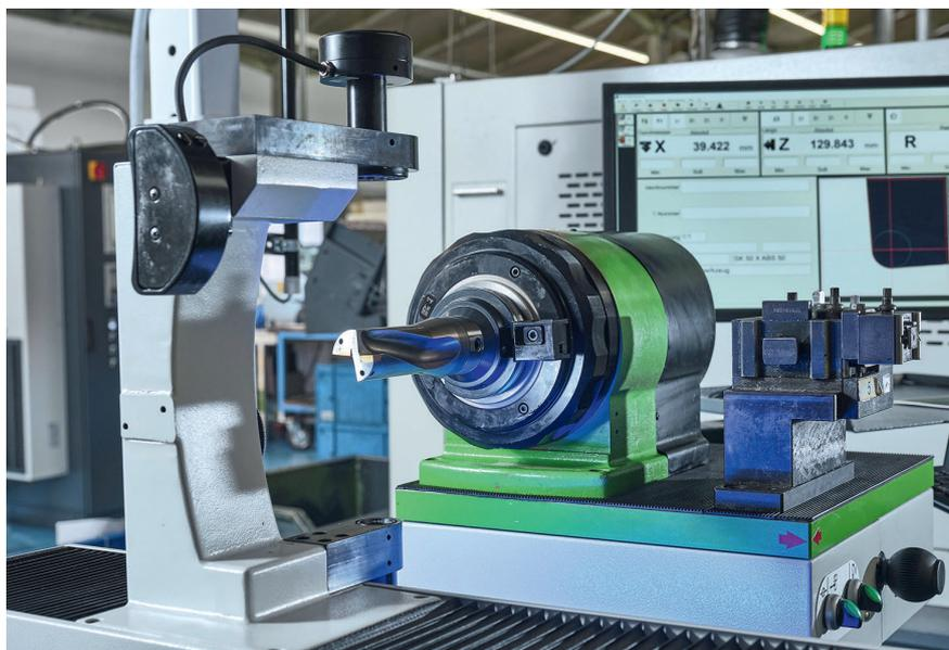
1 Der Tisch des bei Danfoss genutzten horizontalen Werkzeugeinstellgerätes ‚Kenova set line H3‘ ist variabel bestückbar mit Werkzeughaltern diverser Schnittstellen wie VDI, HSK, PSC oder Index, einer manuellen Spindel sowie speziellen Aufbauten © Kelch, Christian Ahrens
